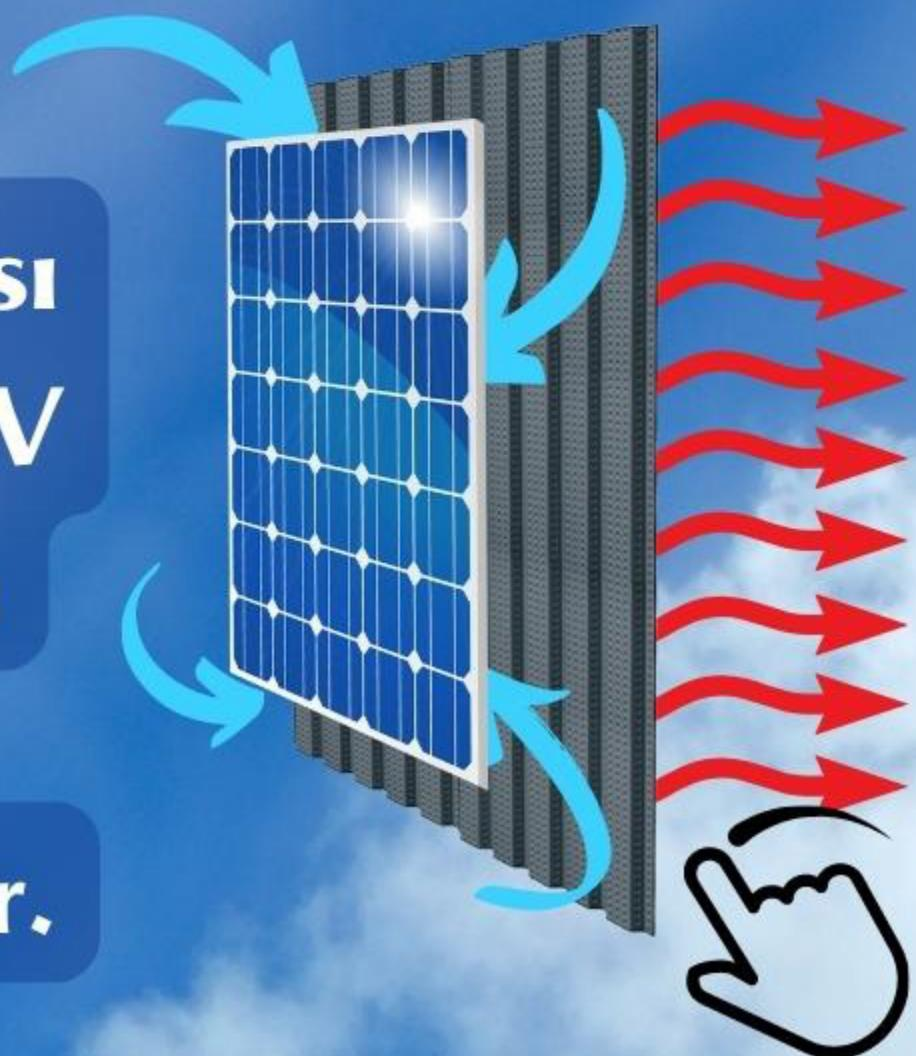
**Bu sayede PV panellerin elektrik üretiminde %10-15 seviyesinde artış sağlatıp kullanım ömürlerini arttırken, SolarWall ise verimi düşmeden ısıtmaya devam eder.**
